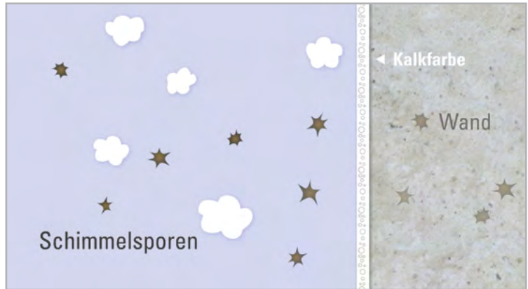
Durch diese hohe Alkalität der diffusionsoffenen Kalkfarben wirken sie schimmelhemmend und geruchsabsorbierend.
