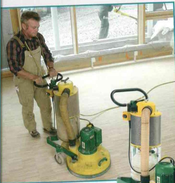
Im Gegensatz zu anderen Einscheibenschleifmaschinen wird die „Trio“ über Räder geführt.
